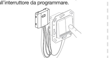
4 Appena passato in modo programmazione, il LED di configurazione si accende (rosso) sul trasmettitore e su tutti i ricevitori a portata radio.
