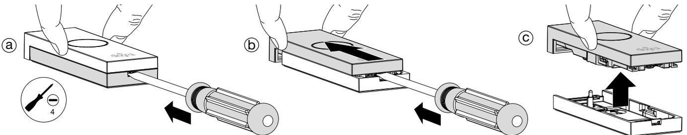
3 Ôter la pile usagée, attendre 2 minutes et insérer la nouvelle pile. Le voyant rouge sur la face avant s'allume 2 s. Refermer le détecteur.
