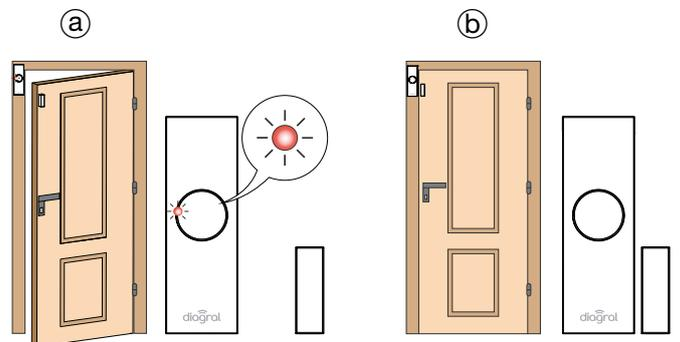
Pendant le mode test, la centrale réagit vocalement à l'ouverture et à la fermeture des issues protégées et énonce :
