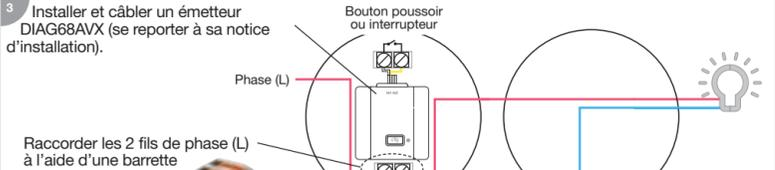
4. Au niveau de l'éclairage, couper les fils... puis les dénuder à 4 mm à l'aide du gabarit présent sur le cache bornes du DIAG65AVX.
