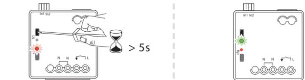
Modifier la durée de minuterie par appuis brefs successifs sur le bouton **fct** du récepteur. La durée de minuterie correspond au nombre de clignotement de la LED de fonction.
