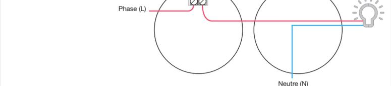
• Câblage après l'installation de l'émetteur DIAG68AVX et du récepteur DIAG65AVX.
