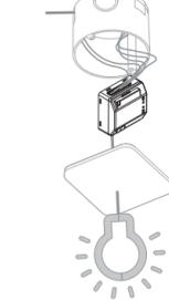
3 Positionner le DIAG68AVX dans la boîte d'encastrement et remonter l'appareillage mural.
