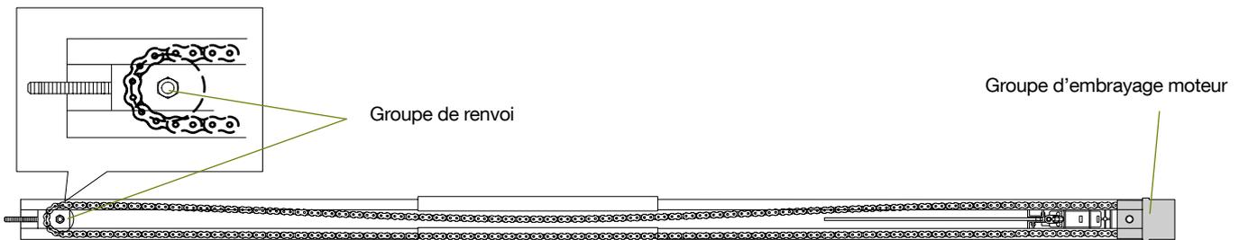
5. Emboîter la patte de fixation dans le rail de guidage puis assembler le groupe de renvoi à la patte de fixation à l'aide du goujon et de l'écrou fournis. **Tendre légèrement la chaîne en vissant l'écrou.**
