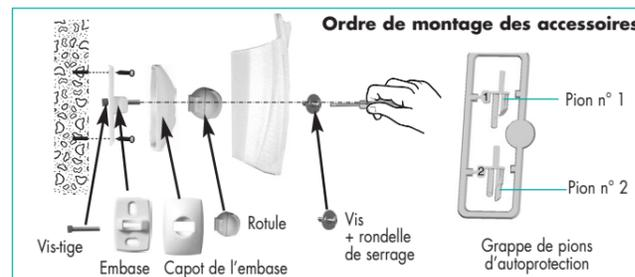
⚠ Pour des raisons de sécurité et de durée de vie des piles du détecteur, le montage du pion d'autoprotection est obligatoire. En cas d'oubli ou de montage incorrect de ce pion d'autoprotection, le voyant test du détecteur clignote en permanence quand celui-ci est clipsé sur son socle.
