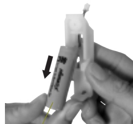
Batteria ricaricabile 908-21X (Bat Li-Ion 3,6 V / 700 mAh)
