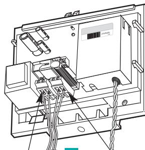
**1** Aansluiting van het te bedienen apparaat van 230 V (max. 1000 W)
