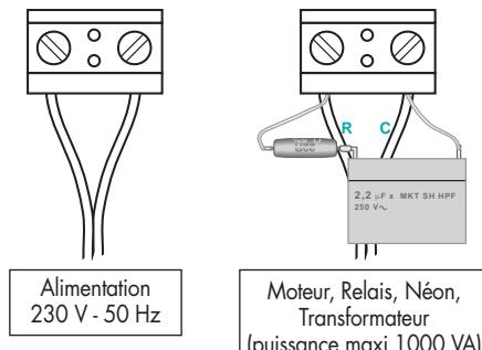
**R :** résistance bobinée 22 Ohms - 3 Watts
