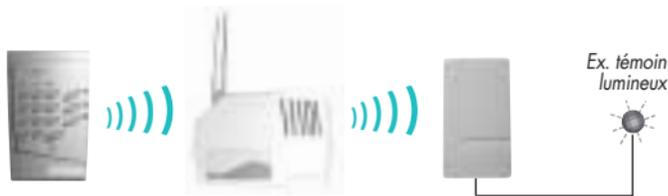
• **Mode Activation sur intrusion** : commander un appareil électrique ou un éclairage en fonction du déclenchement du système d'alarme, avec activation suite à une intrusion et désactivation après une durée programmée.
